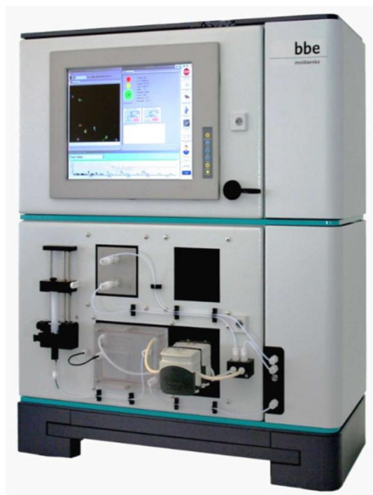
图 7.2.4-1 大型蚤毒性仪示意图
