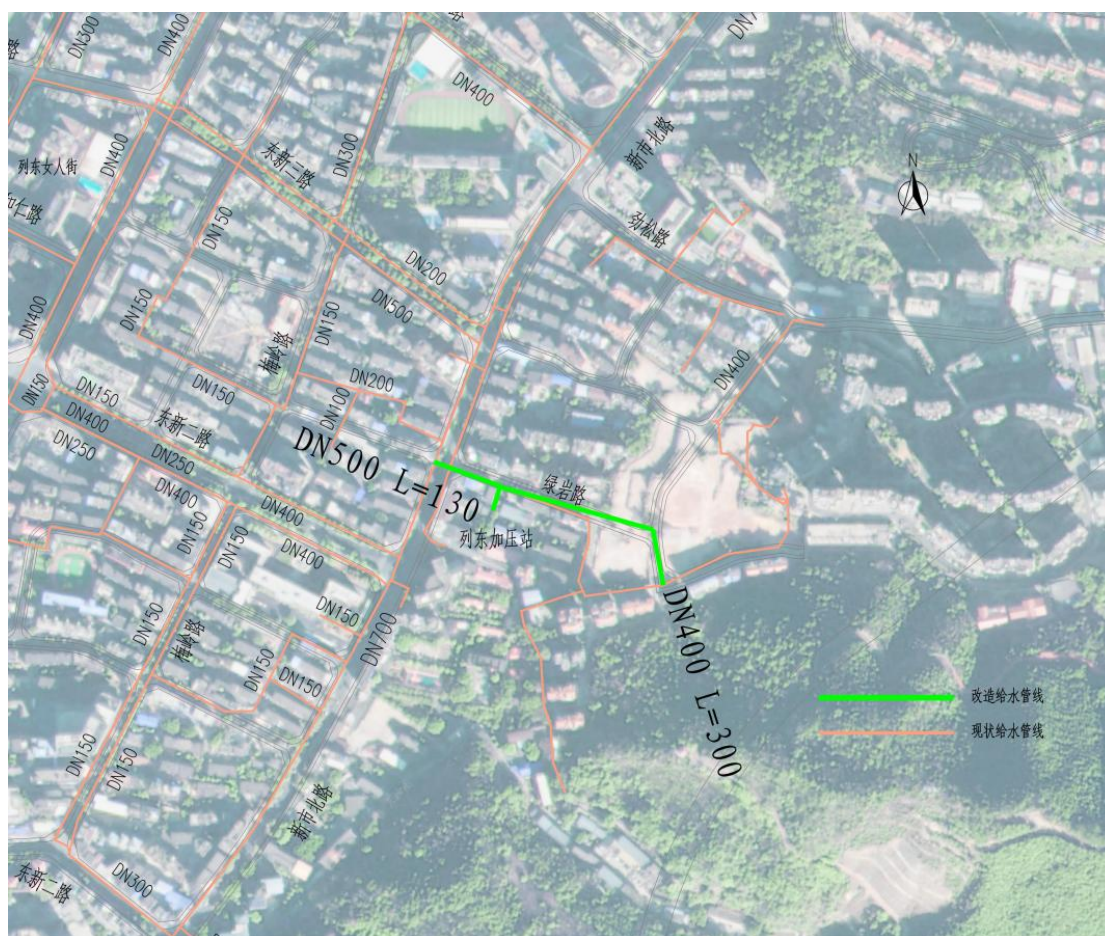
图 5-3 列东加压站进出水管改造方案
